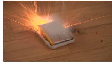
モバイルバッテリー火災の再現映像
