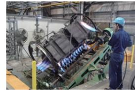
私たちは、回転成形という手法を用いて、強度・耐薬品性に優れたポリエチレン製品を生産しています。主な製品には、農業などで使用するローリータンク(水運搬タンク)や丸型・角型容器、工業施設で使用する薬品貯槽タンクなどがあります。
