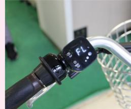
電源 ON！押すたびにアシストの強さが変わる
